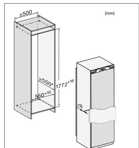
\* Der deklarierte Energieverbrauch wurde mit einer Nischentiefe von 560 mm ermittelt. Das Kältegerät ist bei einer Nischentiefe von 550 mm voll funktionsfähig, hat aber einen geringfügig höheren Energieverbrauch.
